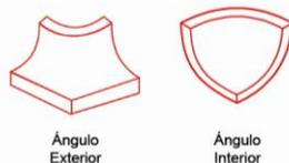
Están fabricados en Zamak, una aleación, no ferrosa, de Zinc con Aluminio, Magnesio y Cobre (según UNE-EN 1774), que permite obtener piezas inyectadas para el perfecto acabado de las esquinas.
